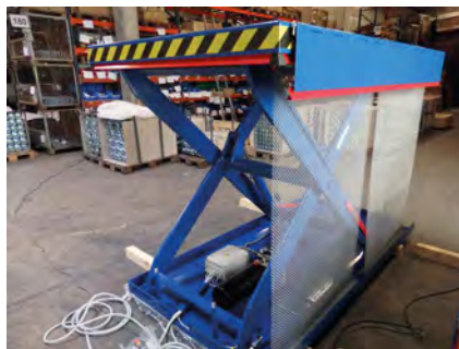
Neuer Hubtisch mit Verladeblech und Welldrahtgitter
