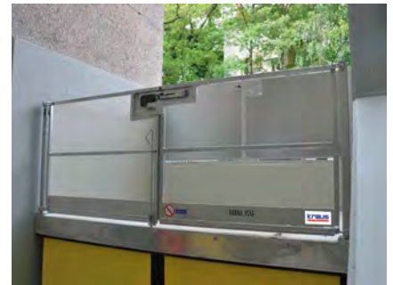
Verzinkter Hubtisch mit Tür und elektrischer Verriegelung, PVC-Rollos Nutzlast: 1.000 kg | Nutzhub: 1.800 mm
